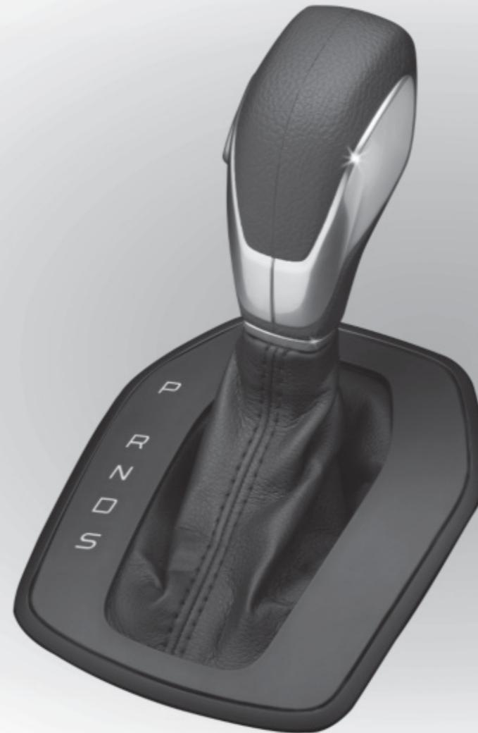
**Ford PowerShift** pruža savršenu kombinaciju udobnosti uporabe automatskog mjenjača uz učinkovitost ručnog. Ovaj automatski mjenjač sa 6 stupnjeva prijenosa u pravom trenutku odabire sljedeći stupanj, a promjena se odvija munjevito brzo i bez ikakvog prekida protoka snage. Ručni način rada omogućuje izmjenu stupnja prijenosa pritiskom na gumb - bez uporabe spojke. (Opcija)
