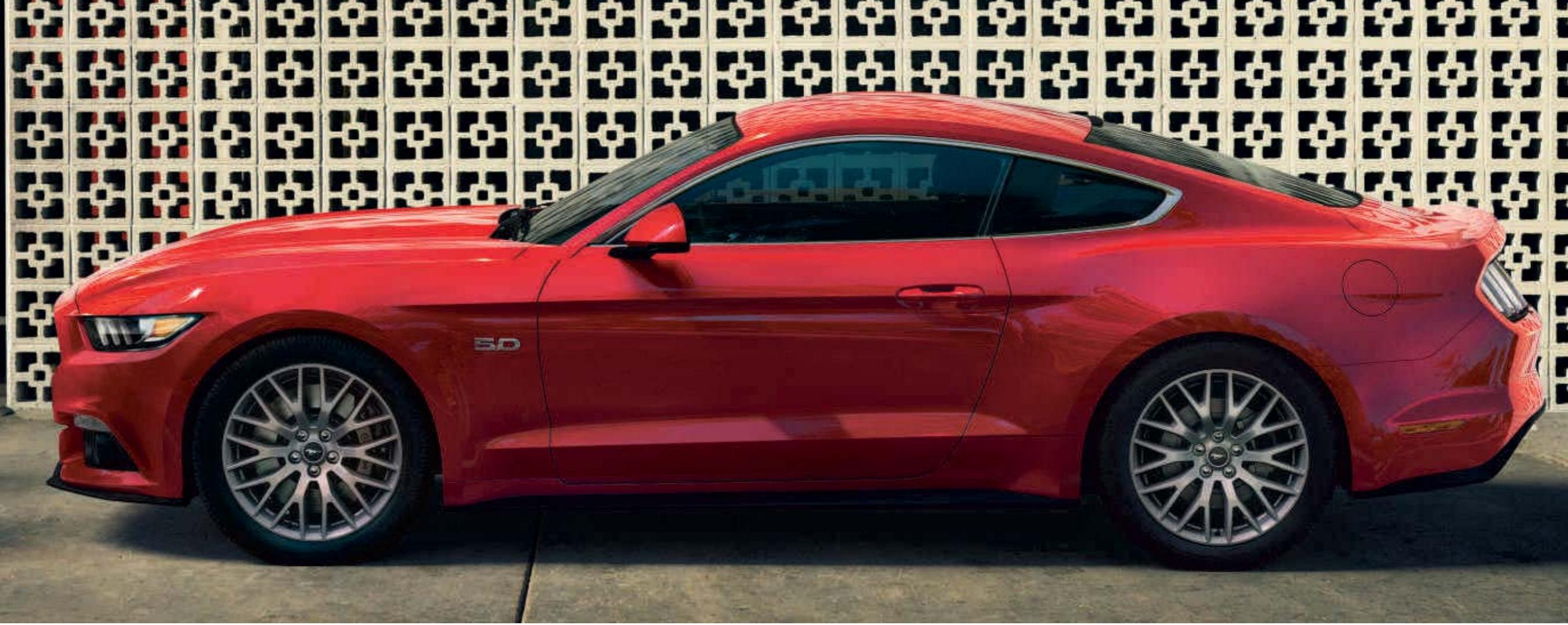
**Aerodinamika** Mustang je prvi Fordov automobil koji će biti opremljen aerodinamičnim zavjesama za prednje kotače koje će voditi zrak preko prednjih kotača. Na stražnjem kraju, konusni oblik karoserije usmjerava zrak iz automobila jer što je veći otpor zraka, to vam je na raspolaganju manja snaga vuče.
